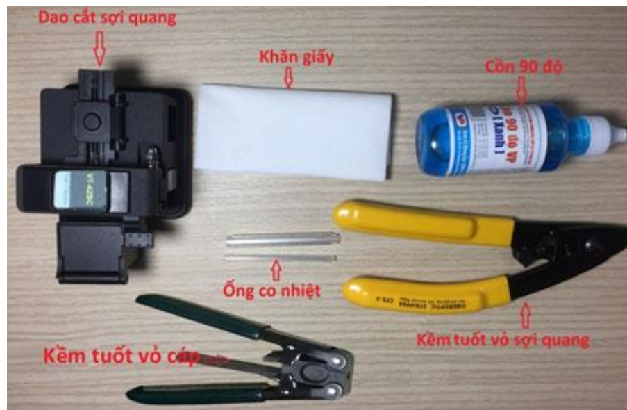
Hình 1.1: Dụng cụ thi công
